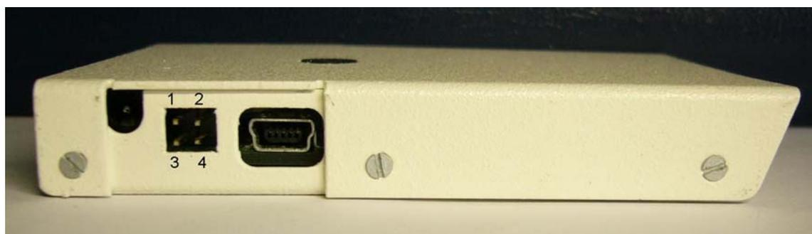
Рис. 1. Вид видеорегистратора со стороны разъемов, слева направо разъемы внешнего питания, внешнего запуска, USB.
