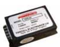
Существенным направлением разработок **Pascall** является создание источников питания и преобразователей напряжения различного назначения. Среди них – малогабаритные преобразователи AC/DC с выходной мощностью  $10\ldots2000$  Вт, многоканальные преобразователи DC/DC для входного напряжения 28 В и выходами на 3.3 В, 5 В, 12 В.
