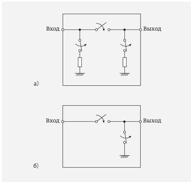
**Рис. 32.** Упрощенные схемы поглощающего ADG901 (а) и отражательного ADG902 (б) переключателей, производимых компанией Analog Devices
