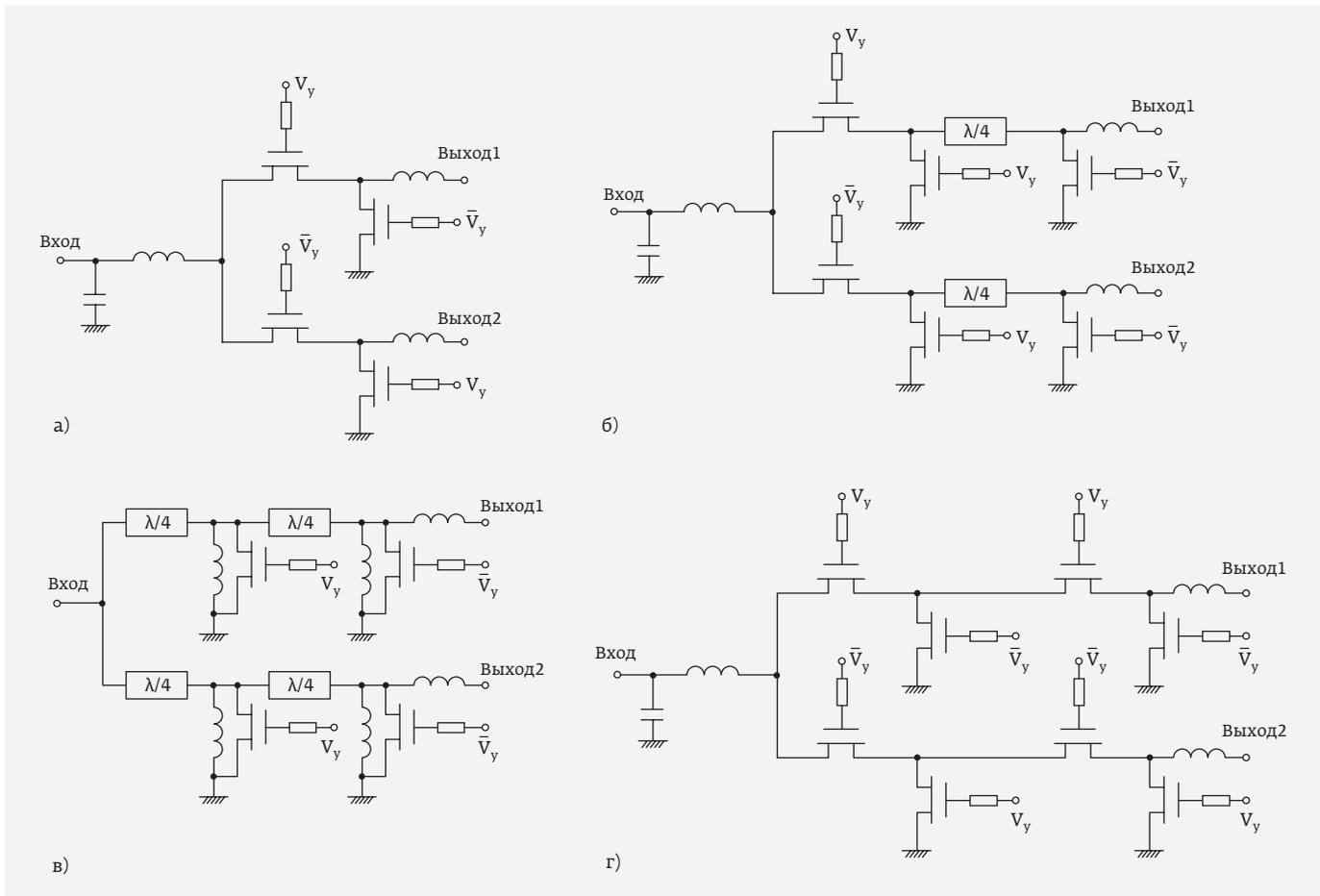
**Рис. 52.** Архитектуры SPDT КМОП переключателей: а - последовательно-параллельная; б - последовательно-параллельно-параллельная; в-параллельно-параллельная; г - каскадная последовательно-параллельная.  $\lambda/4$  - четвертьволновые отрезки СВЧ линий передачи
