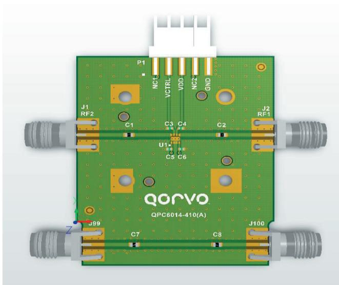
**Рис. 34.** Отладочная плата для SPST-переключателя QPC6014 (компания Qorvo)
