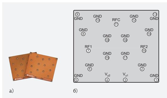
**Рис. 43.** Внешний вид выпускаемых компанией Peregrine Semiconductor SPDT-переключателей PE42525 и PE426525 (а) и расположение контактов на нижней поверхности их flip-chip корпусов (б). RF1, RF2, RFC – СВЧ-порты переключателей, V<sub>y1</sub>, V<sub>y2</sub> – порты для подключения управляющих сигналов, GND – «земля»
