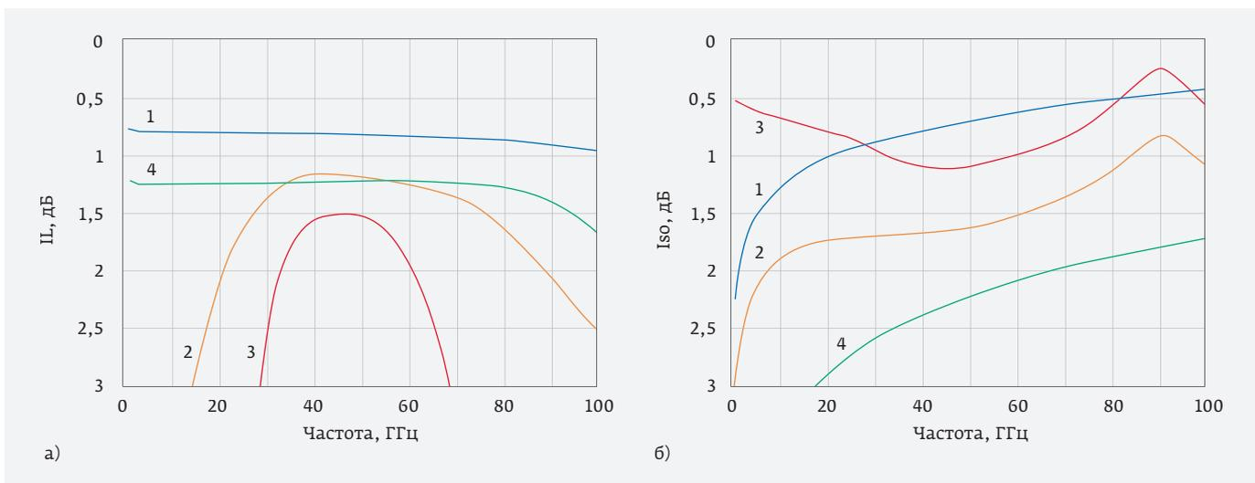
**Рис. 53.** Расчетные зависимости вносимых потерь  $IL$  и развязки  $Iso$  для различных архитектур: 1 - последовательно-параллельная (см. рис. 52 а); 2 - последовательно-параллельно-параллельная (см. рис. 52б); 3 - параллельно-параллельная (см. рис. 52в); 4 - каскадная последовательно-параллельная (см. рис. 52г)
