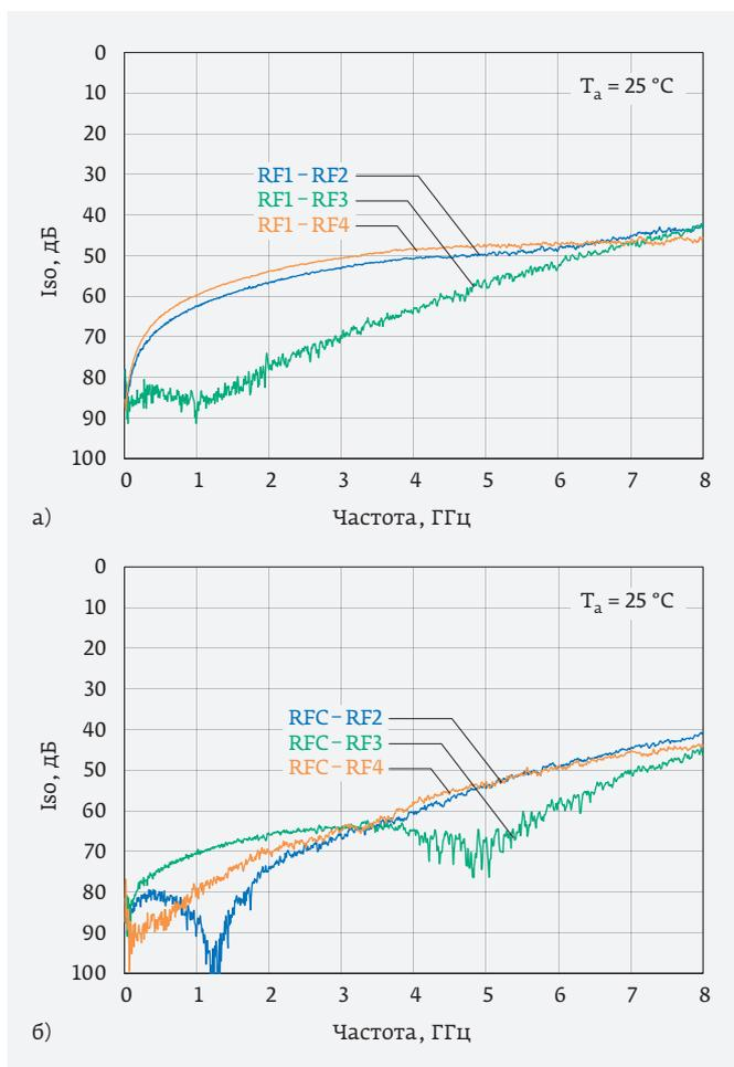
**Рис. 45.** Межпортовые развязки Iso в 4-позиционном переключателе QPC6044 при прохождении сигнала от RFC до RF1: а – развязка между RF1 и RF2, RF1 и RF3, RF1 и RF4; б – развязка между RFC и RF2, RF3, RF4
