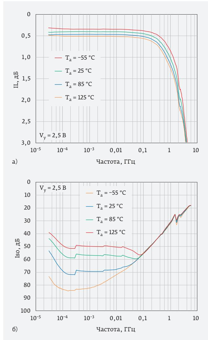
**Рис. 33.** Зависимости вносимых потерь  $IL$  и развязки  $Iso$  от частоты при различных значениях температуры окружающей среды  $T_a$  (микросхема ADG901-EP, компания Analog Devices).  $V_y$  – управляющее напряжение
