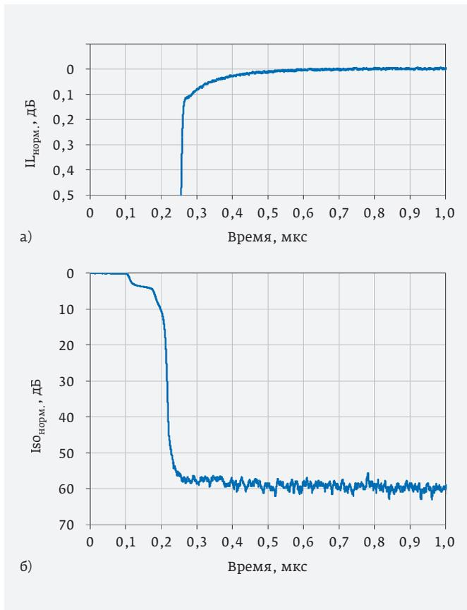
**Рис. 47.** Характер изменения во времени нормированных вносимых потерь  $L_{\text{норм.}}$  при переключении из положения «разомкнуто» в положение «замкнуто» (а) и нормированной развязки  $I_{\text{со.норм.}}$  при переключении из положения «замкнуто» в положение «разомкнуто» (б) (микросхема F2915, компания IDT)
