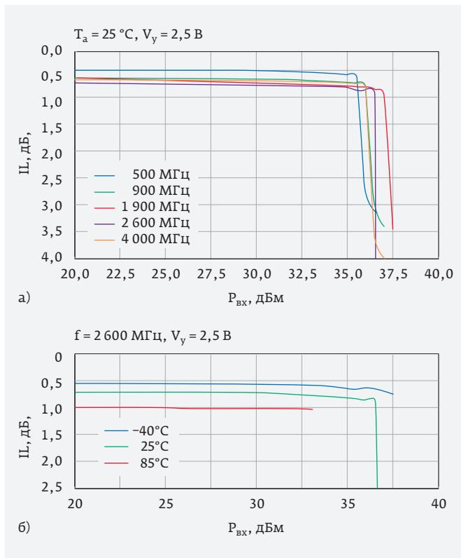
**Рис. 38.** Зависимости вносимых потерь IL от уровня входной мощности P<sub>вх</sub> для различных частот (а) и температур окружающей среды (б) в SPDT-переключателе RFSW6224 (компания Qorvo)
