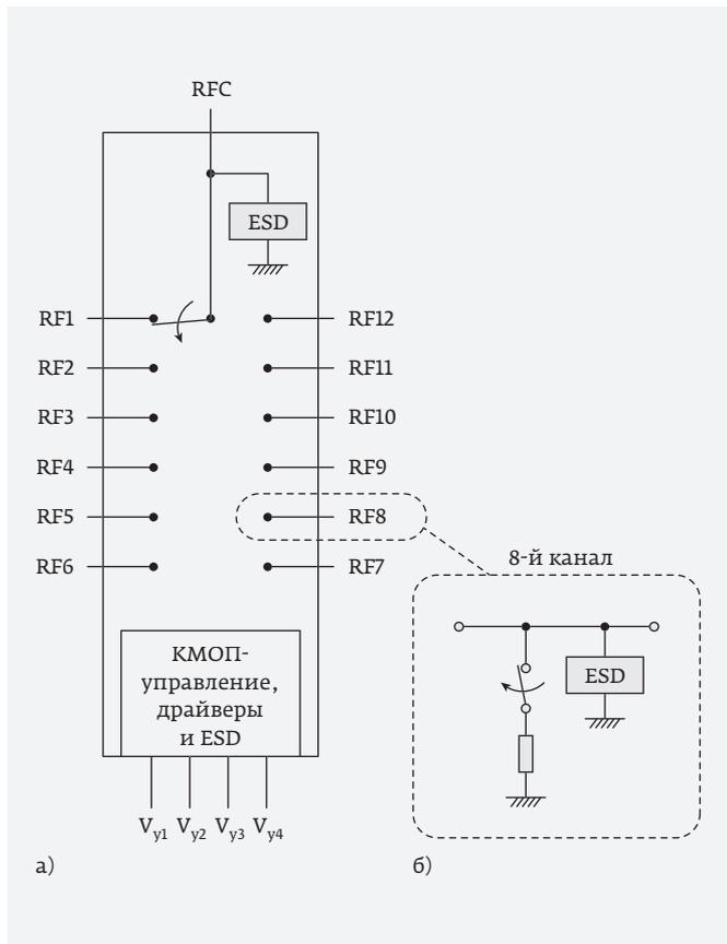
**Рис. 48.** Упрощенная функциональная схема 12-позиционного переключателя PE426412 (а) и упрощенная принципиальная схема одного из каналов (б) (компания Peregrine Semiconductor). ESD – блок защиты от статического электричества
