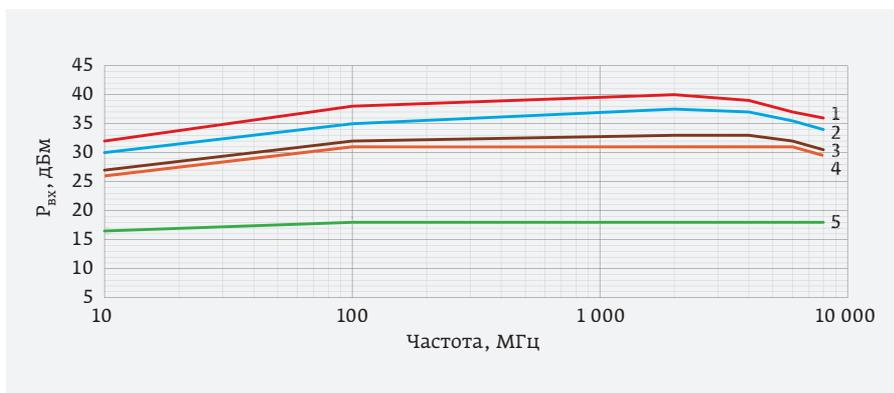
**Рис. 49.** Зависимость входных паспортных значений мощностей от частоты в 12-позиционном переключателе PE426412 (компания Peregrine Semiconductor): 1 –  $P_{\text{1дБ}}$ ; 2 –  $P_{\text{0,1дБ}}$ ; 3 – максимально допустимая импульсная входная мощность; 4 – максимально допустимая непрерывная входная мощность; 5 – максимально допустимая мощность на внутренних нагрузках в отключенных каналах
