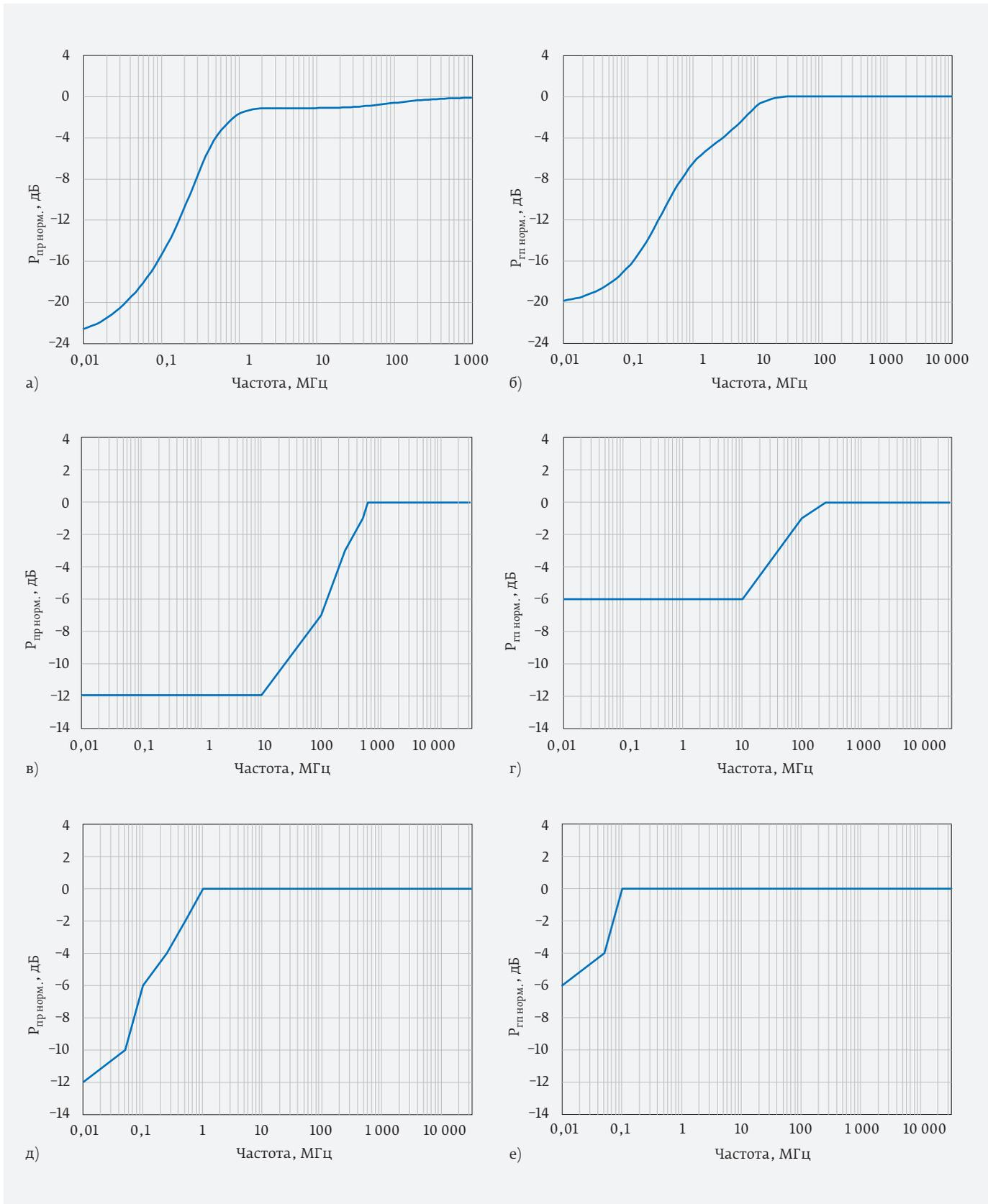
Рис. 41. Уменьшение мощностей  $P_{пр}$  (а, в, д) и  $P_{гп}$  (б, г, е) на низких частотах относительно их номинальных значений в переключателях HMC1118 (а, б), ADRF5020 (в, г), ADRF5021 (д, е)
