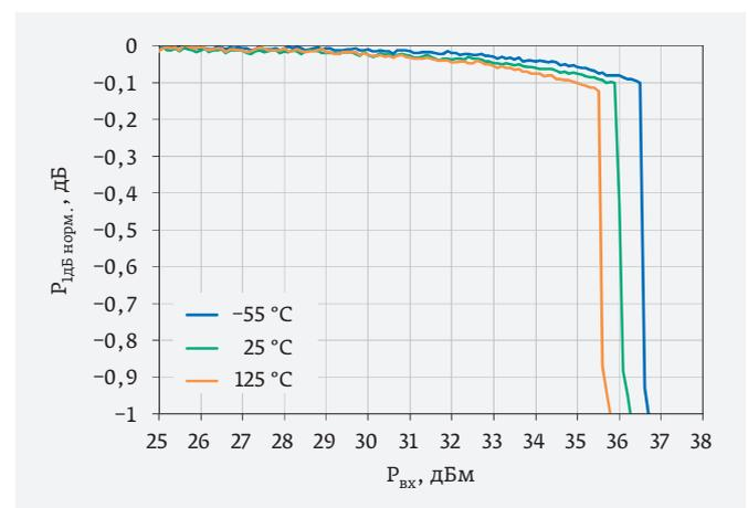
**Рис. 40.** Зависимость нормированной мощности  $P_{\text{идб}}$  от входной мощности  $P_{\text{вх}}$  для трех значений температуры окружающей среды (микросхема F2932 компании IDT)
