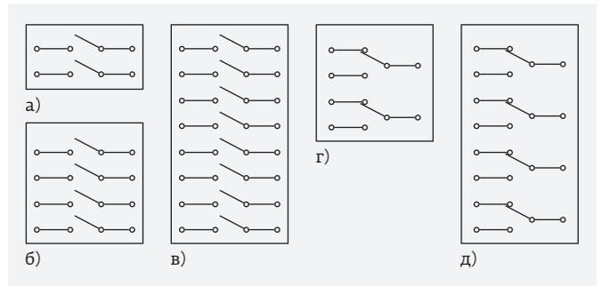
**Рис. 51.** Примеры размещения нескольких однопольных СВЧ-переключателей в одном корпусе микросхемы: а – SPST×2; б – SPST×4; в – SPST×8; г – SPDT×2; д – SPDT×4
