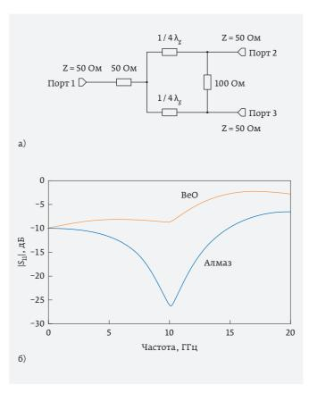
Рис. 12. Делитель Вилкинсона: а - схема, б - обратные потери в полосе рабочих частот (данные компании EMC Technology)
