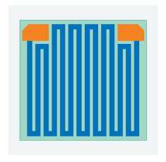
Рис. 9. Чип-резистор на подложке SiO<sub>2</sub>, компания US Microwaves
