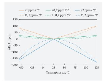
Рис. 6. Зависимость сопротивления от температуры для сплавов C, K и Z (данные компании Vishay)
