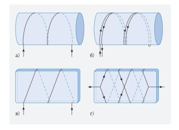
Рис. 3. Типы намоток проволочных резисторов: а - обычная; б - бифилярная (двухзаходная); в - плоская; г - Айртона-Перри
