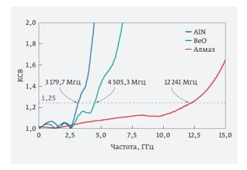
Рис. 11. КСВ контактных площадок (данные компании EMC Technology)
