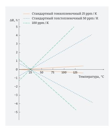
**Рис. 5.** Сравнение ТКС тонко- и толстопленочных резисторов
