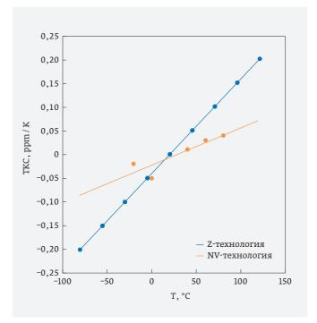
Рис. 7. ТКС сплавов NV и Z (данные компании нииэмп)
