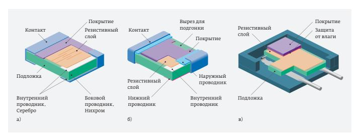
Рис. 4. Конструкции пленочных резисторов: а - тонкопленочный, компания Phycomp [3], б - толстопленочный, компания MSI [4], в - металлофольговый, компания Vishay [5]
